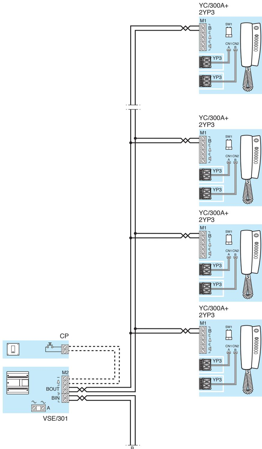
Sezione di impianto videocitfonico (sistema X1) con 3 derivati interni intercomunicanti serie Lynea aventi unica chiamata dal posto esterno e attivazione del video sul derivato interno MASTER.
